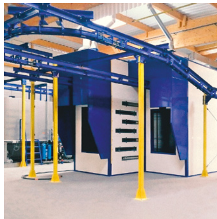
➤ Tunnel di cottura e asciugatura fino a 250°C
