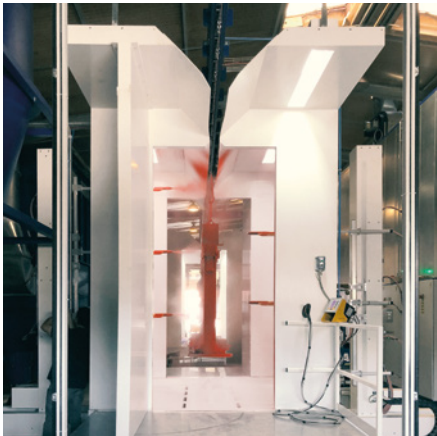
➤ Cabine automatiche di verniciatura a polvere in PVC con ciclone per cambio colore rapido
