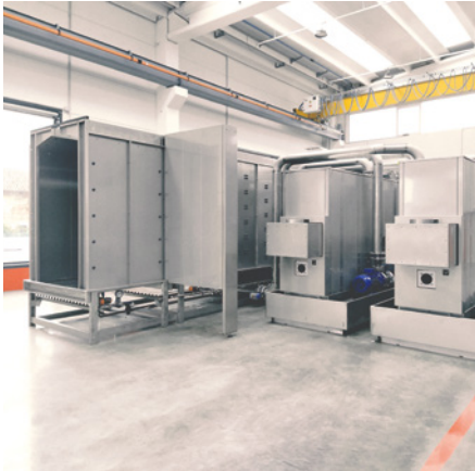
➤ Cella di lavaggio multi metal
