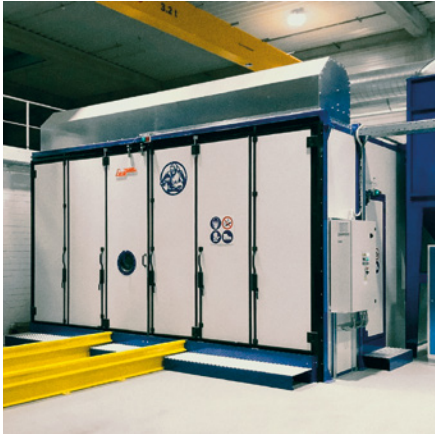
➤ Cabine di granigliatura con sistema di recupero totale della graniglia
