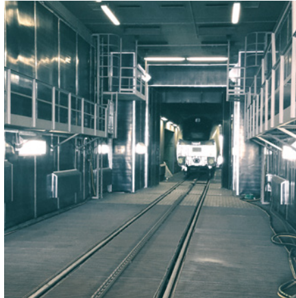
➤ Cabine di granigliatura con sistema di recupero totale della graniglia
