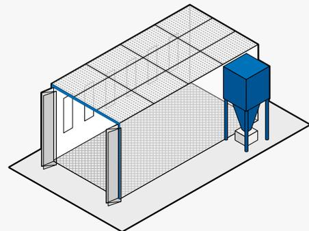
➤ Cabine de peinture à flux vertical avec entrée d'air de toit filtrée et aspiration au sol
