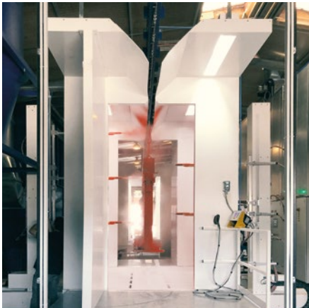
➤ Automatische Pulverbeschichtungskabinen aus PVC mit Zyklon für schnelle Farbwechsel
