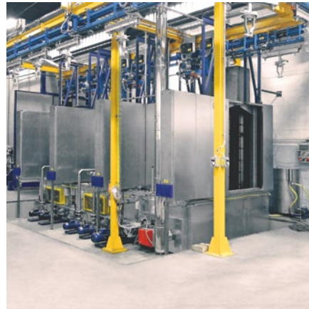
➤ Step by step Waschtunnel Heißentfettung, 2 Spülungen + VE-Spüle
