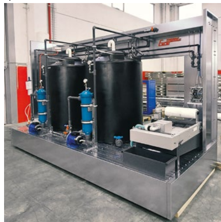
➤ Skid für Flüssigkeitsrückgewinnung mit geschlossenem Zyklus
