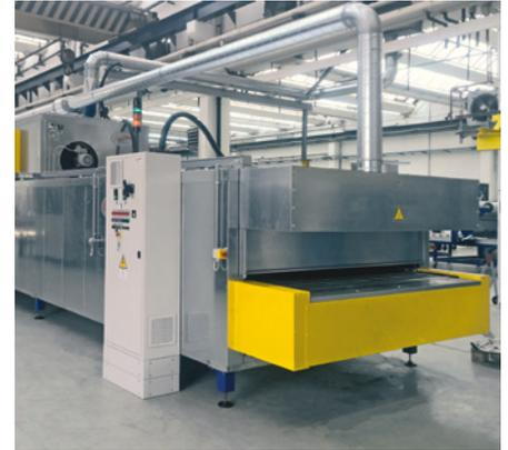
➤ Forno con trasportatore a nastro continuo
