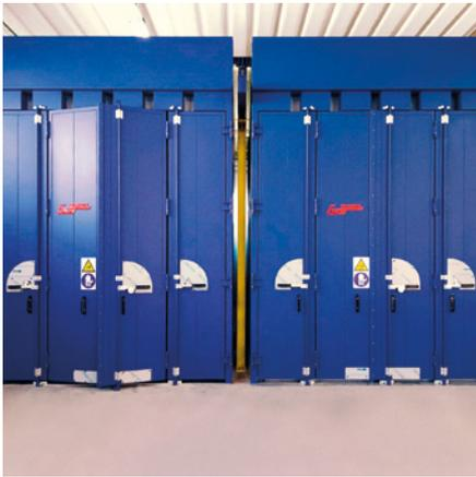
➤ Forni di polimerizzazione a gas fino a 250°C
