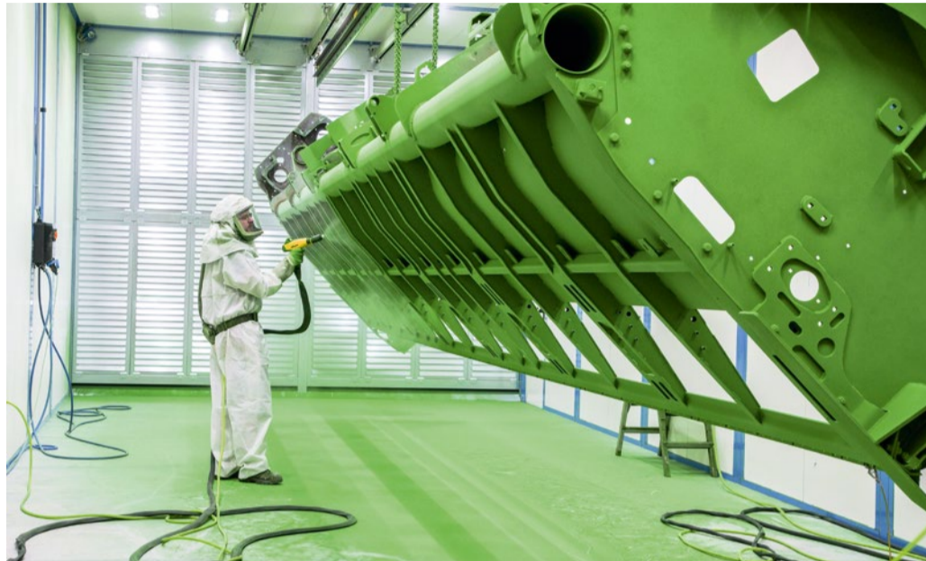
Die Pulverapplikation erfolgt manuell. Dafür stehen den Beschichtern zwei Pulvergeräte zur Verfügung. Die Werkstücke können in jedem RAL-Ton und weiteren Sonderfarben beschichtet werden.
