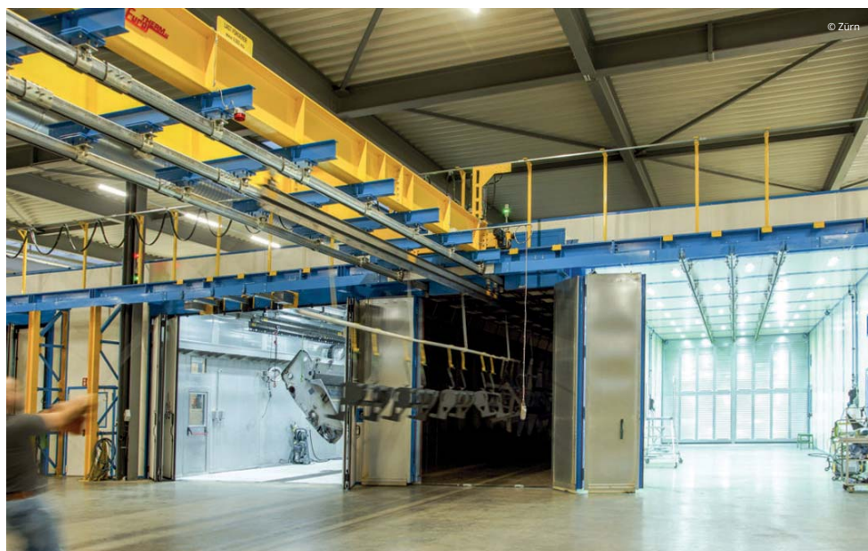
I pezzi escono dal forno di polimerizzazione.
