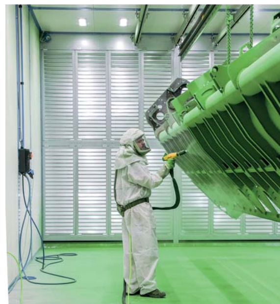
Applicazione manuale della polvere.
